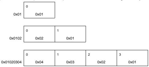
Figure 3-6, Data encodings ELFDATA2MSB
